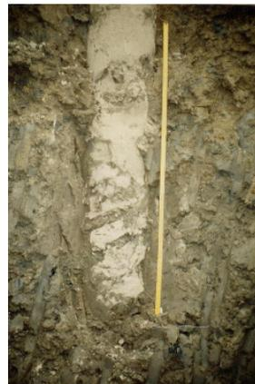
Verpresste Dichtmasse ohne Verzahnung im Bohrloch
