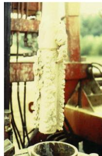
Bohrloch-Fräse nach der Plombierung
