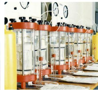
Prüfung und Optimierung der Durchlässigkeits- und Verpresseigenschaften verschiedener Dichtmassen
