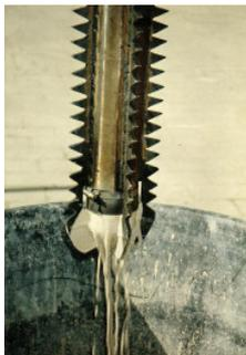
Bohrloch-Fräse mit Dichtmasse
