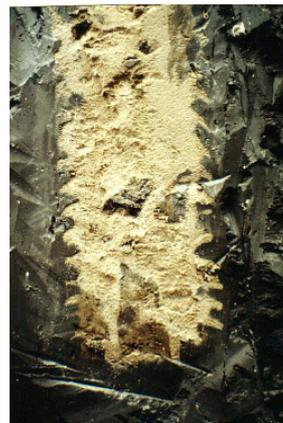
Dichtmasse nach Einsatz der Bohrlochfräse
