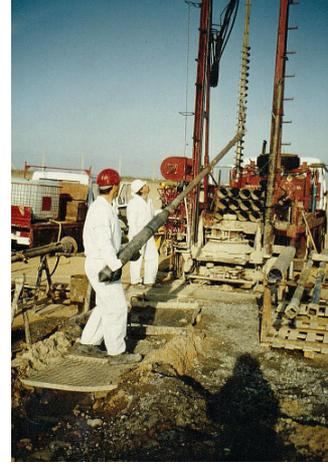
Einsatz der ORKUS-Sonde für die Probenentnahme
