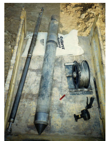
ORKUS-Sonde (Mitte) mit mechanischem Öffnungsgestänge (links)
