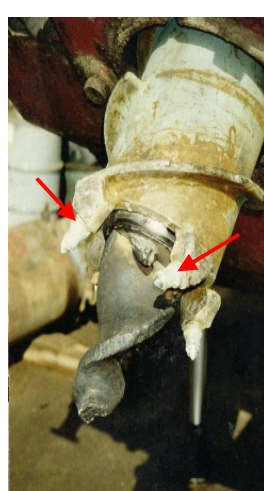
Hohlbohrschnecke mit modifiziertem Vorschneider und Verpressöffnungen (rote Pfeile) zur Injektion der Dichtungssuspension
