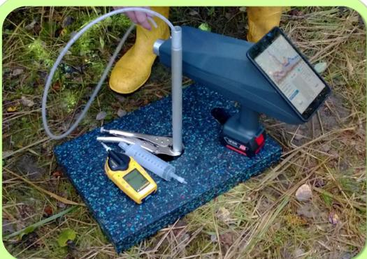
Messung der Bodenluft in 3,0 m Tiefe im Bohrloch von BS 11
