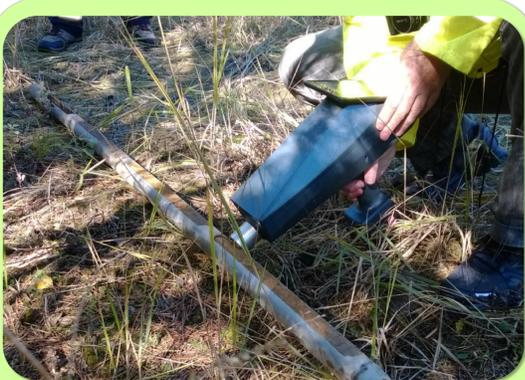
Direkte Messungen am Bohrgut (3,0 – 4,0 m) von BS 10 für LHKW-Tiefenprofile
