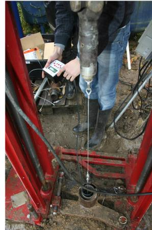
Direkte Probenahme der Bodenluft in der Horizontschicht über die „HBS-Sampler“-Steuereinheit
