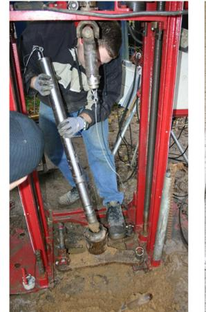
Nach der Beprobung wird die Pilotspitze aus der MHBS entfernt, aus dieser wird die Beprobungseinheit entnommen
