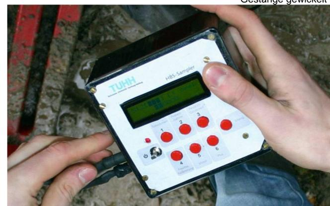
Für die MHBS entwickelter „HBS-Sampler“, zur direkten Messung der Bodenluft an der Pilotspitze und der Steuerung des Beprobungssystems
