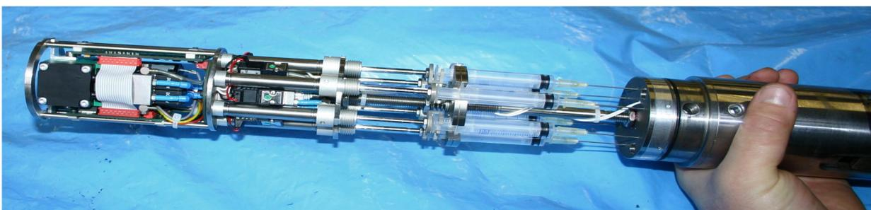
Bodenluft-Beprobungssystem in der Pilotspitze. Im ersten Schritt des Feldversuches sind Zwei der Sechs Kammern des Systems mit Bodenluft befüllt worden
