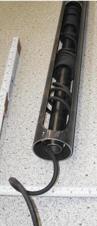
Zum effektiven Einbringen in die MBHS wird das Kabel um das Gestänge gewickelt
