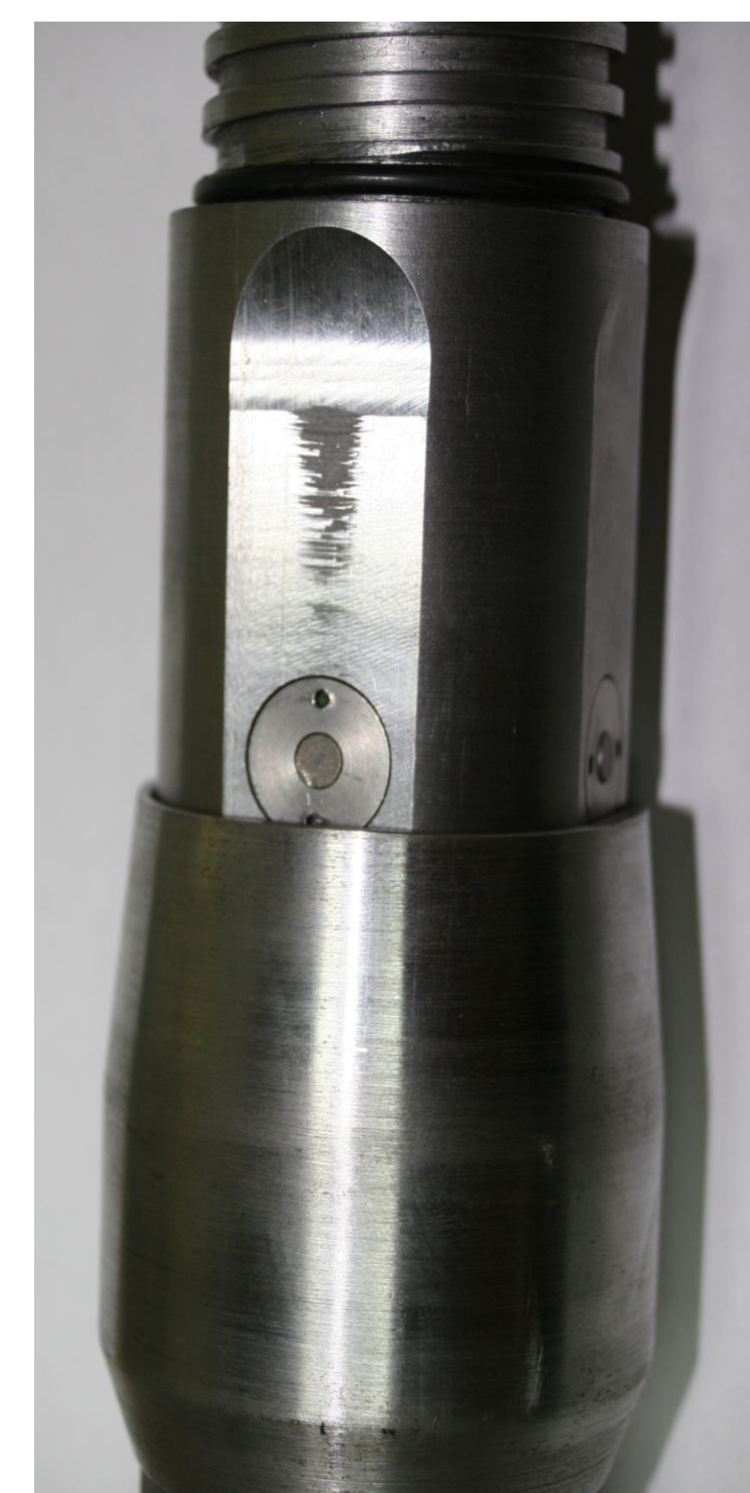
Gaseinlass-System mit Metall-Fritten eingeschraubt in Aluminium-Hülsen, die in das Stahl-Sondengehäuse integriert wurden
