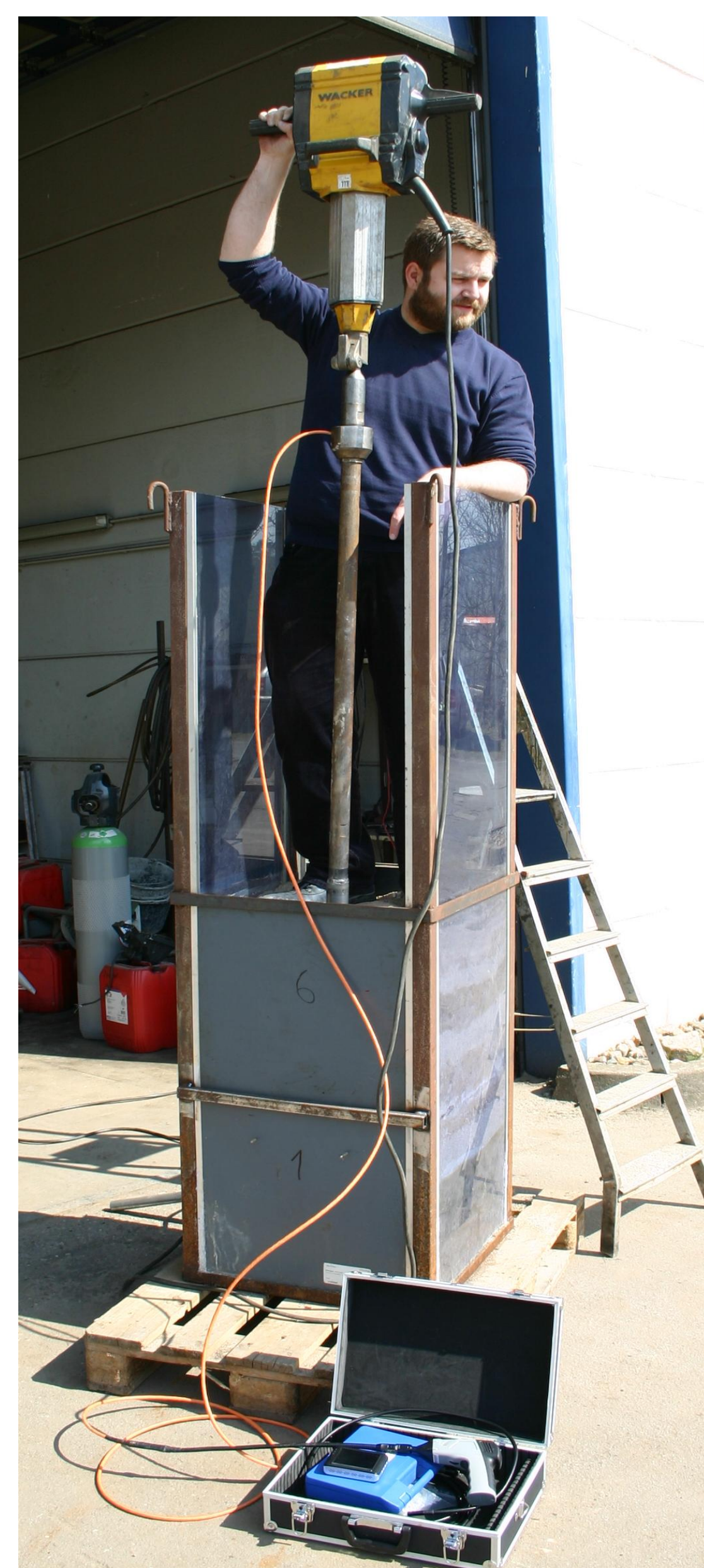
Erweiterung des Testcontainers mit Einlassöffnungen zur Einleitung von Gasen in permeable Bodenschichten
