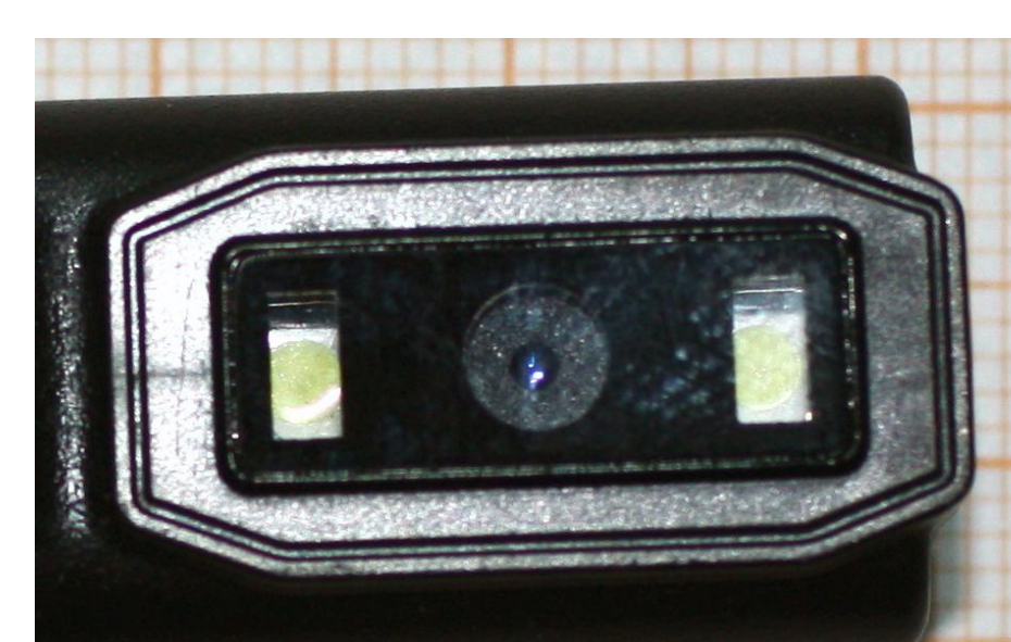
Mikrokamera mit 2 LED-Lampen, Quarz-/Saphirglas-Fenster sowie Abdeckplatte und gegossene Elastosil-Dichtung
