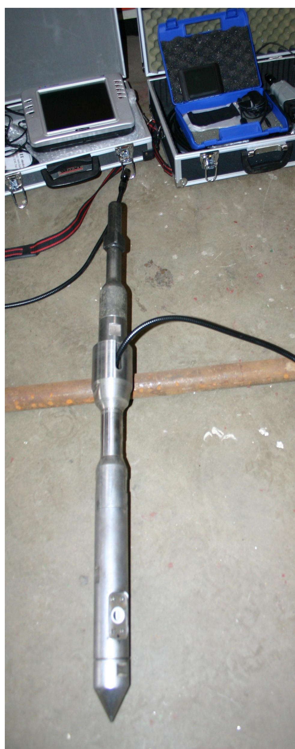
Ramm-Kameraeinheit mit Kabel-Auslass und Schlagkopf
