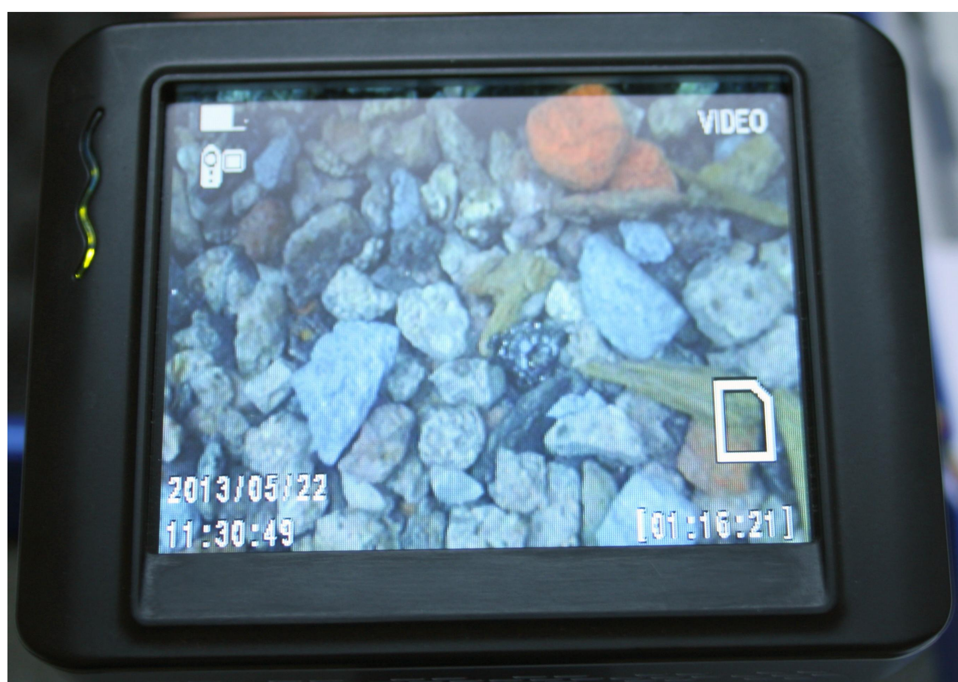
Dichtungen mit Silikon in Kombination mit Teflon ergaben eine sehr gute Abdichtung des Sondengehäuses. Die Entkopplung der Saphir-Fenster vom Gehäuse gelang durch eine Einfassung mit Elastosil bei ausreichendem Randschluss. Die LED-Ausleuchtung ist regelbar und das Video-Signal wird per Funk oder Kabel während des Rammvorganges auf einen kleinen Monitor übertragen bzw. gespeichert.
