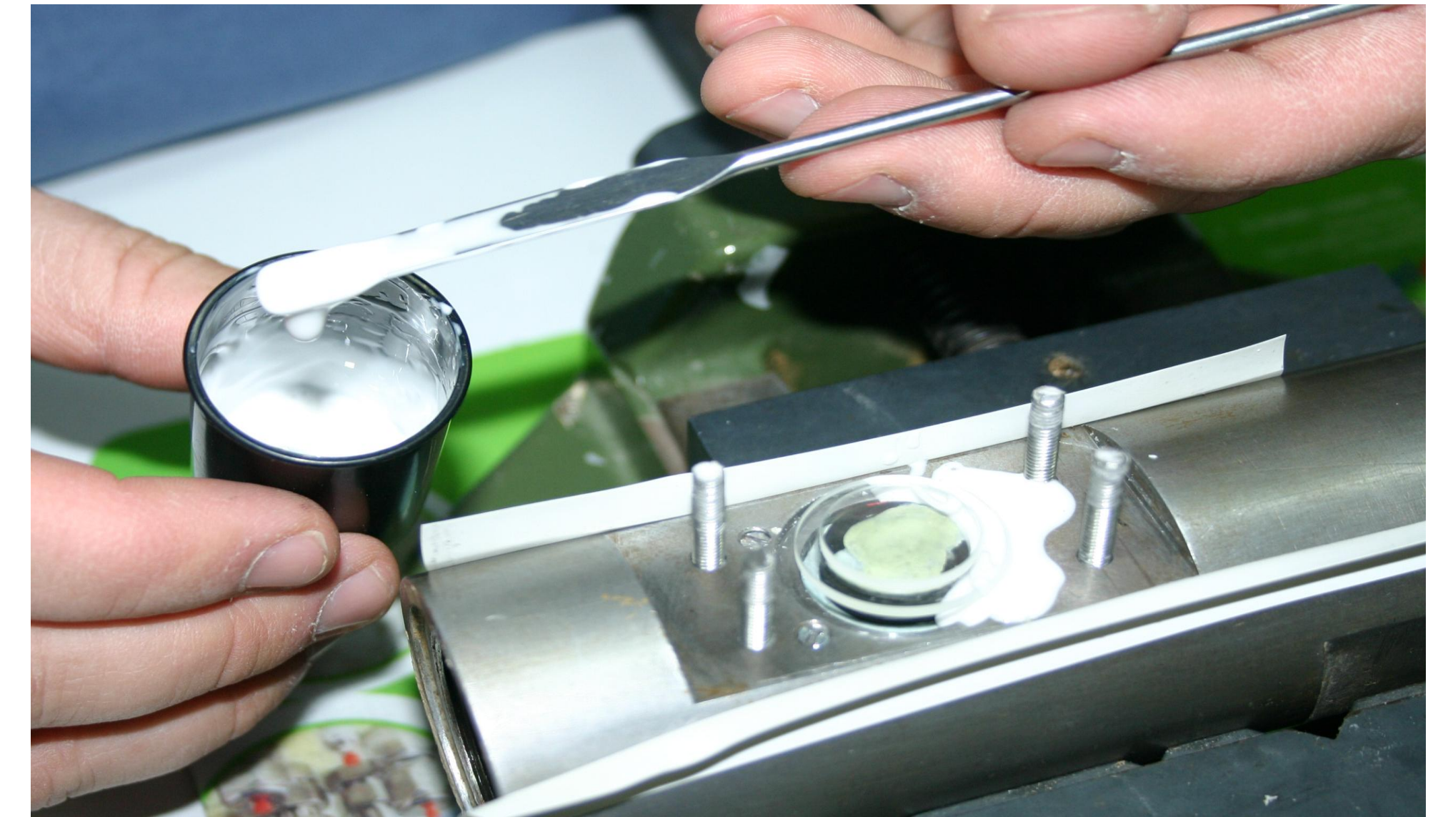
Herstellung von verschiedenen Dichtungen zur Einfassung der Kamerafenster und der Sondengehäuse-Abdichtung
