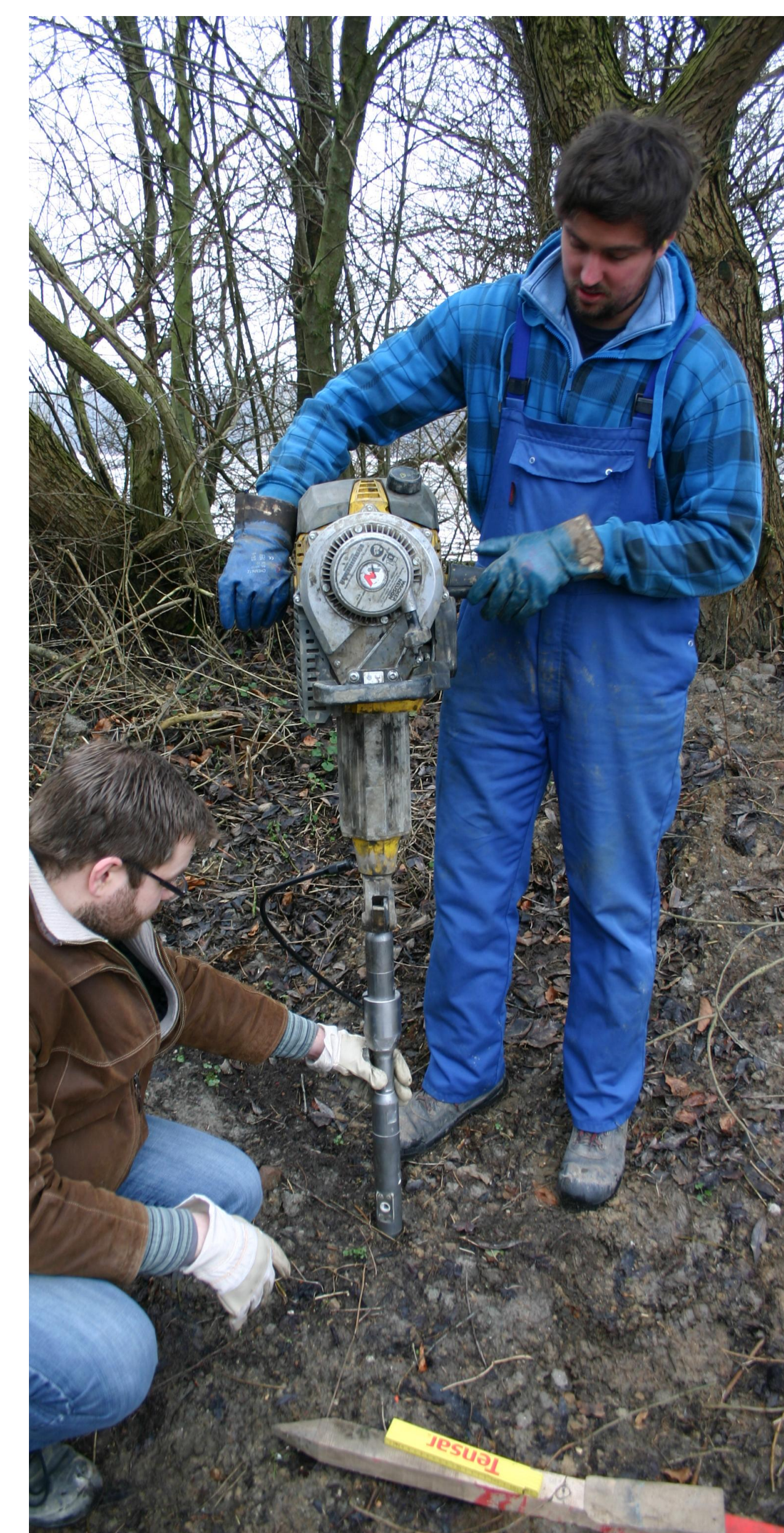
Feldversuche mit der Rammkamera in bauschutthaligen Auffüllungsböden zur Prüfung der Dichtungen und der Mineralglasfenster sowie zur Härtung des Systems
