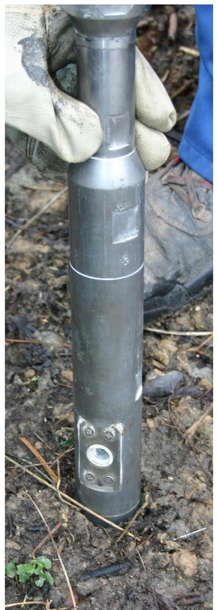
Feldversuche mit der Rammkamera in bauschutthaligen Auffüllungsböden zur Prüfung der Dichtungen und der Mineralglasfenster sowie zur Härtung des Systems
