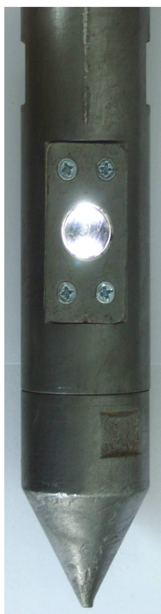
Dichtungen mit Silikon in Kombination mit Teflon ergaben eine sehr gute Abdichtung des Sondengehäuses. Die Entkopplung der Saphir-Fenster vom Gehäuse gelang durch eine Einfassung mit Elastosil bei ausreichendem Randschluss. Die LED-Ausleuchtung ist regelbar und das Video-Signal wird per Funk oder Kabel während des Rammvorganges auf einen kleinen Monitor übertragen bzw. gespeichert.
