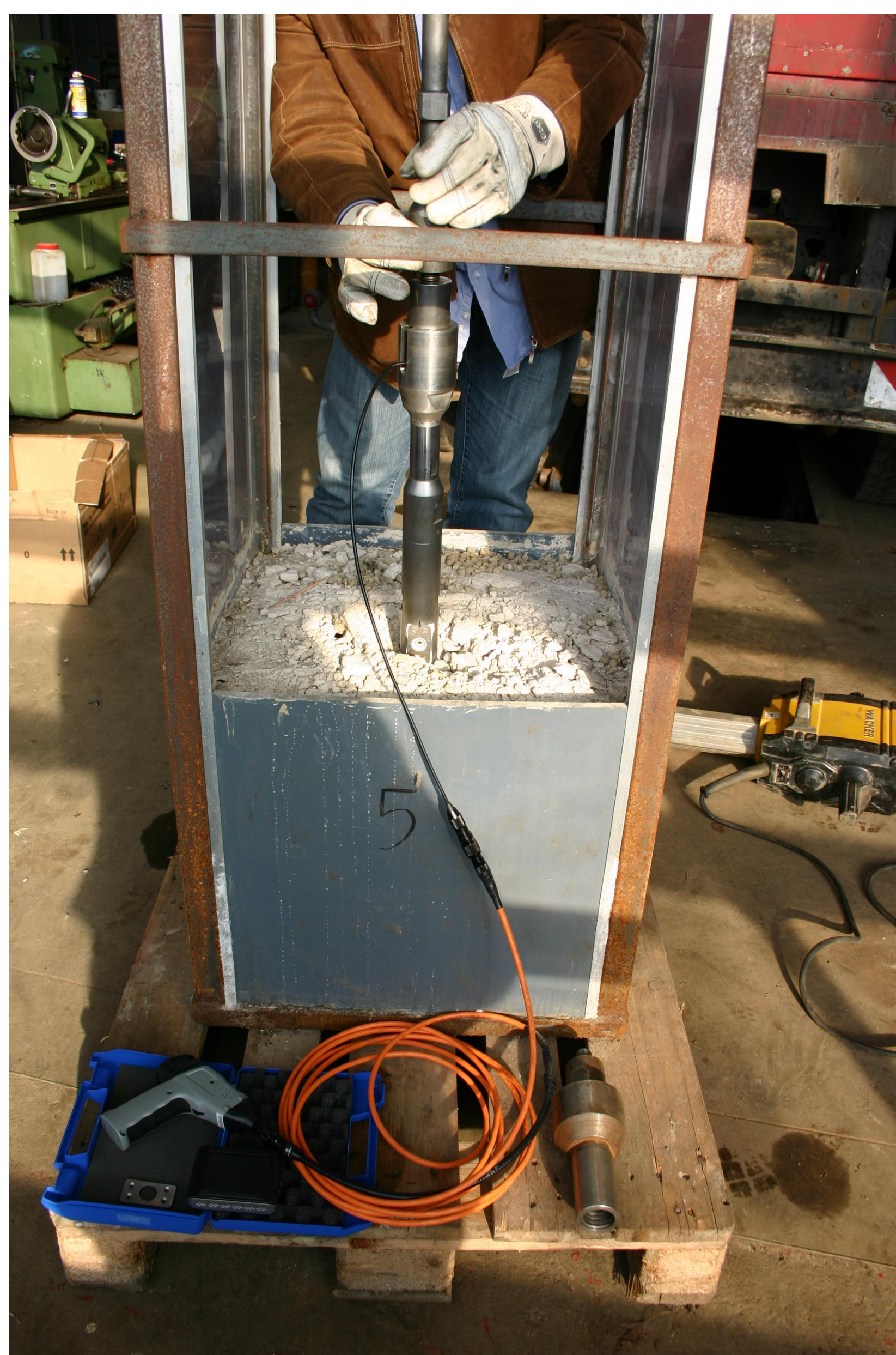
Testcontainer mit eingebauten Bodenschichten unterschiedlicher Korngröße, Farbe und Zusammensetzung
